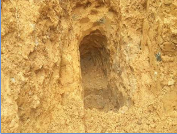
Presencia de bocaminas edificadas sin procesos tecnificados, por lo que existe riesgo alto de deslizamientos
