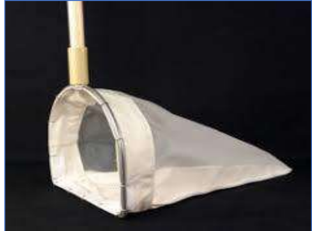
Red tipo "D" para la colección de macroinvertebrados acuáticos en cuerpos hídricos de mayor profundidad (BioQuip Inc 13 )
